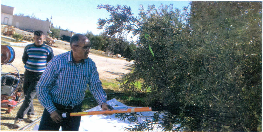
صورة 21: آلة قطف تعمل بالطاقة الكهربائية.
