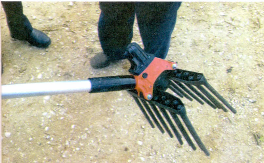
صورة 18: أمشاط قطف زيتون تعمل على بضغط الهواء
