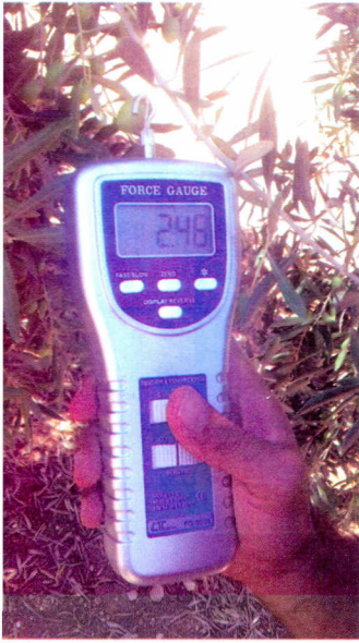
صورة 8: جهاز قياس قوة فصل الثمرة.
